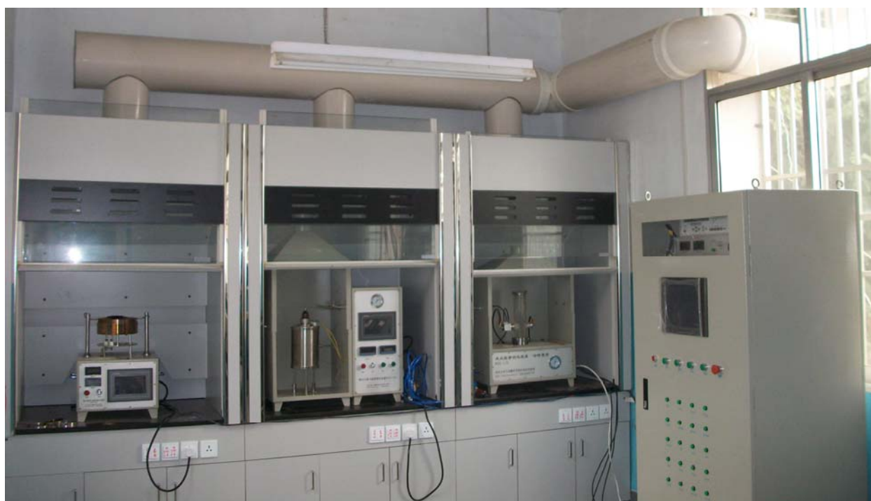
图 4 安装在通风橱中的粉尘层着火温度测试系统
