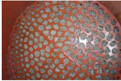
图 3 一次过滤层中的塑料填料(底视图)
